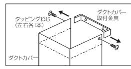
②ダクトカバー取付金具の壁面取付け
