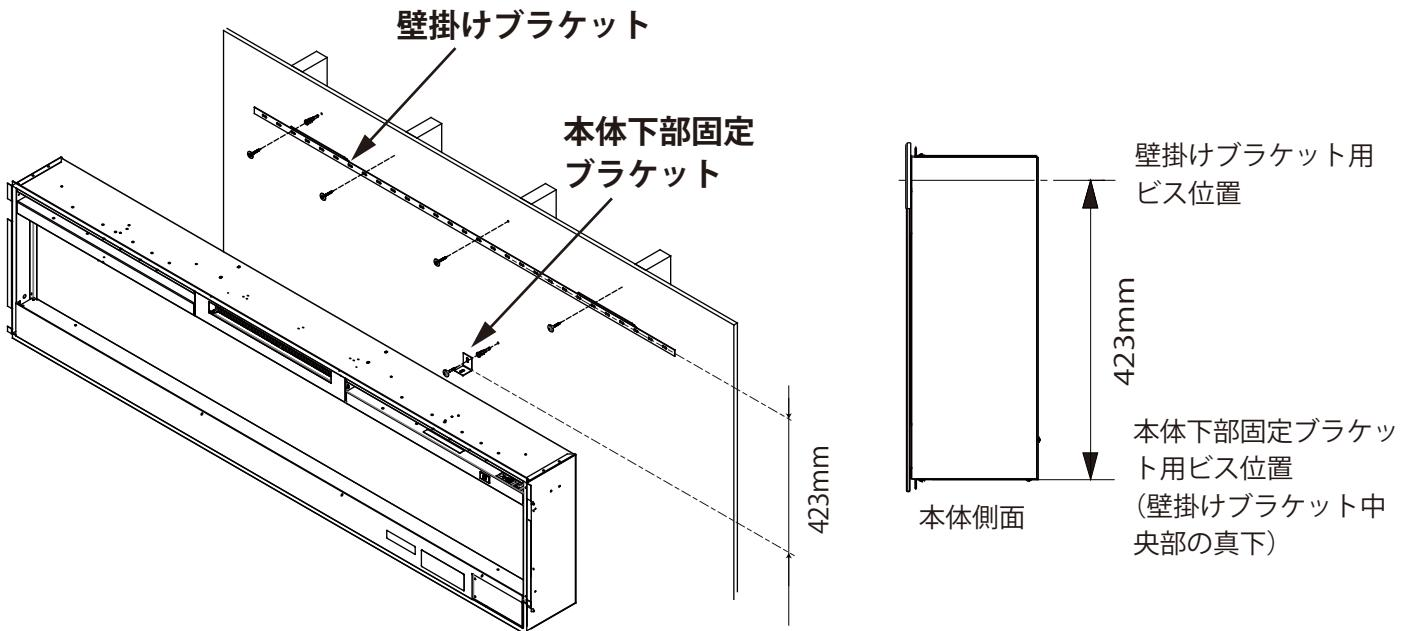
⑤本体底面中央部に取り付けられている固定ビスを一度取り外します。これは後ほど、本体下部固定ブラケットと本体を固定する際に使用します（下図参照）。
