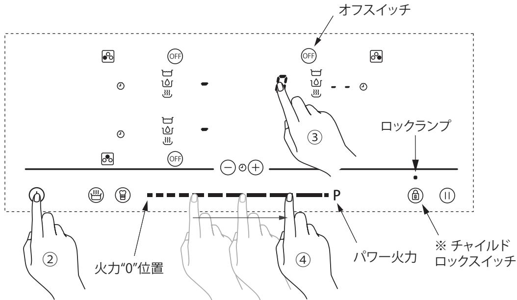
※ 本機に初めて通電した際は、キーロックがロック(ロックランプが点灯)されていますのでロックスイッチ (锁定开关) に1秒以上タッチしてロックを解除してください。ロックランプが消灯します。
