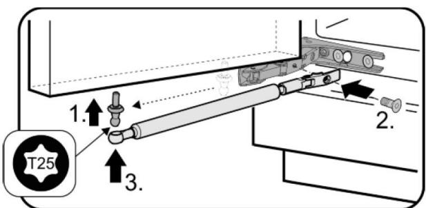
▶作業の始めにソフトシステムを外した場合は、取付けボルトの位置をスライドさせて(1)、再度ソフトシステムを取付けてください。
