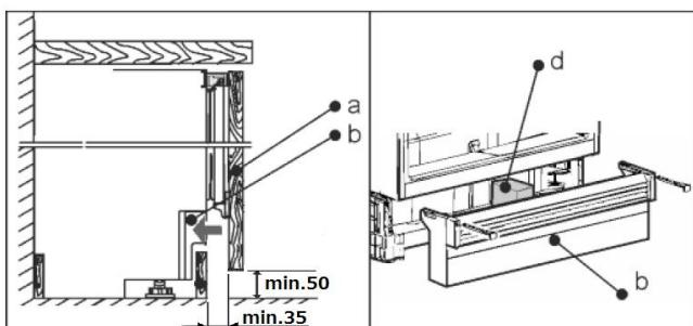
○"a"のドア材の下端は、床面よりmin.50ミリのクリアランスを取ってください。
