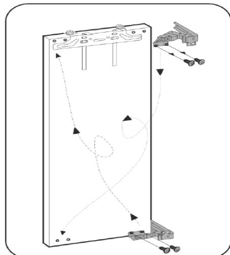
▶ ヒンジを外してください。矢印のように位置を入れ替えて取付けてください。
