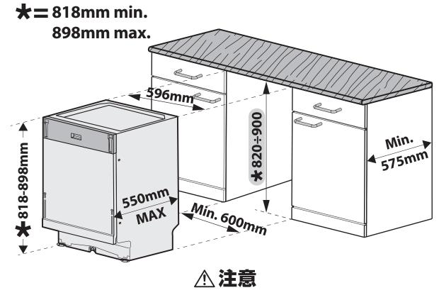
カーペット、フローリングなどを製品設置後に後貼りした場合、設置した面と引き出しする正面側に段差が出来ます。修理や点検の際に製品を引き出せず、改修工事が必要になる等の問題が発生しますので、絶対に行わないでください。
