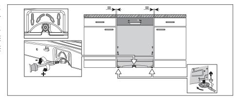
製品の真上のカウンター(前垂れなど)からは必ず2mm以上離すように高さを調整してください。ドアの開閉時に接触し、破損、不具合等が発生します。
