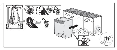
ホース類を押し潰さないように ゆっくりと奥へ押し込み、ドア材 と左右キャビネット、ドアなどと の隙間が等分になるように調整 し、調整脚を上下させて微調整 を行います。
