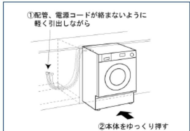
隣接キャビネットにある配管引き出し穴（ $\phi 60$ ）より給水管・排水管・電源コードを引出しながらビルトインしてください。
