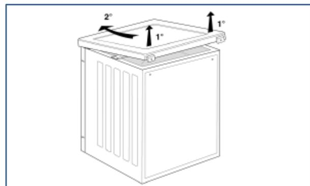
トップパネル背面の 1/4 ビス2箇所を外して、トップパネルを取り外してください。
